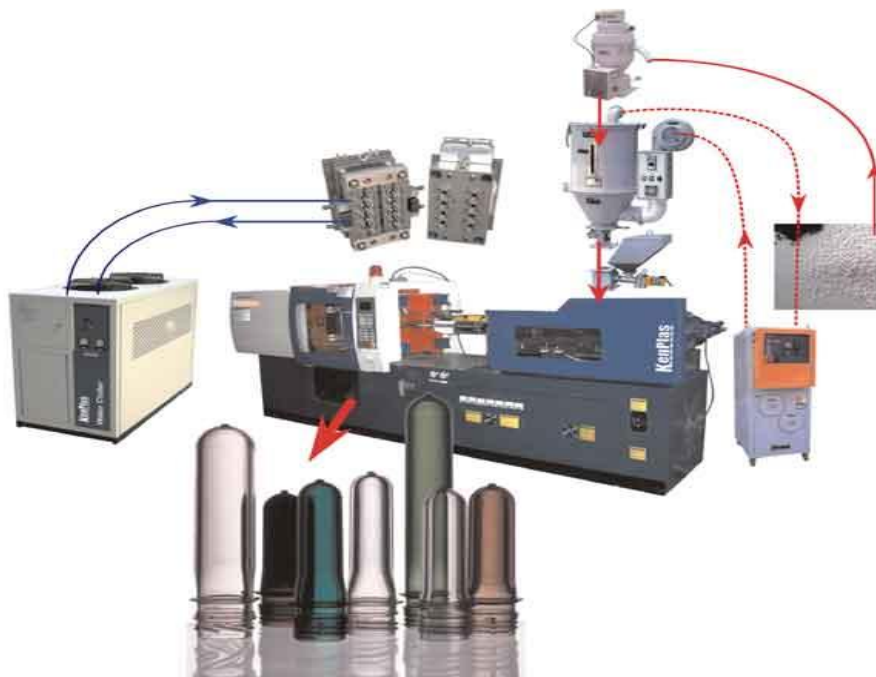
شکل ۲- نمایی از فرآیند تولید پریفرم و بطری پت
